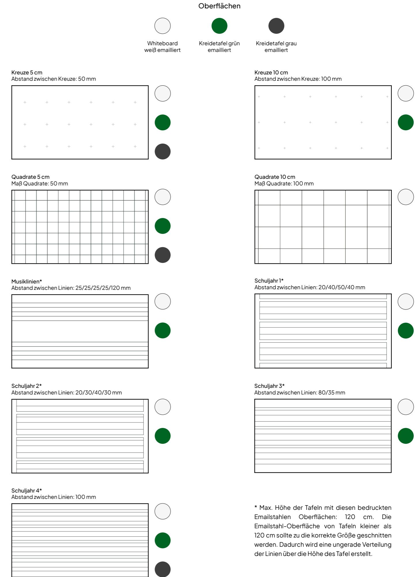
\* Max. Höhe der Tafeln mit diesen bedruckten Emailstählen Oberflächen: 120 cm. Die Emailstahl-Oberfläche von Tafeln kleiner als 120 cm sollte zu die korrekte Größe geschnitten werden. Dadurch wird eine ungerade Verteilung der Linien über die Höhe des Tafel erstellt.
